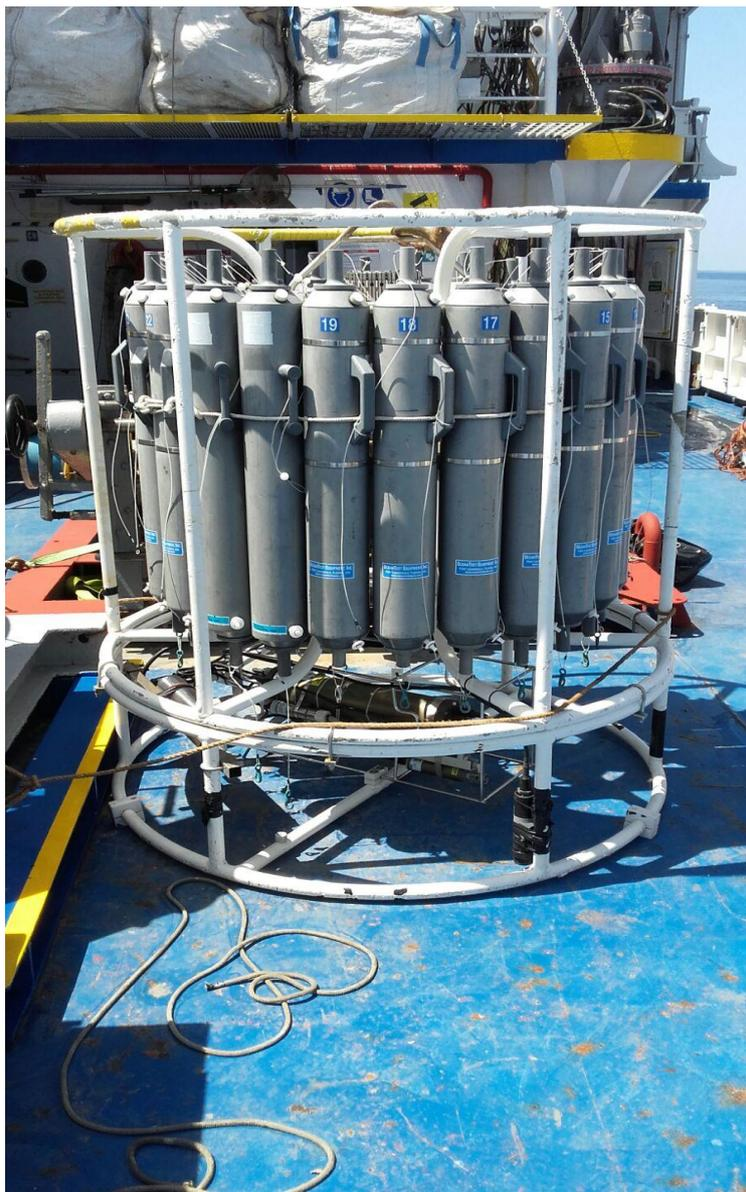
**Figura 9:** per il campionamento è stata usata una Rosette munita di bottiglie Niskin
