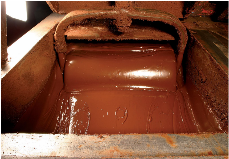
Macchina concatrice, in particolare si tratta di un miscelatore a rullo ( www.huffingtonpost.com )
