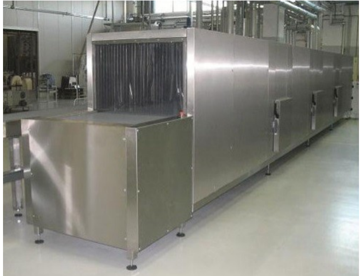
Un tunnel frigorifero (www.tecnococ.it)
