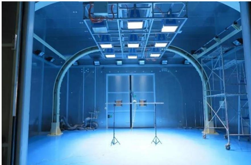
Figura 9 Nuovo centro di ricerca per la simulazione di eventi atmosferici, laboratorio estivo: andamento della luce (minime 5° massime 60°) e del vento. In un esperimento è stato soffiato il vento ad una velocità di 20 m/s verso un pezzo di roccia di dimensioni 5x5x5 ottenuta da Mogao. Dopo ben 3 minuti 2/3 della roccia erano stati danneggiati | Riferimenti immagine 中
