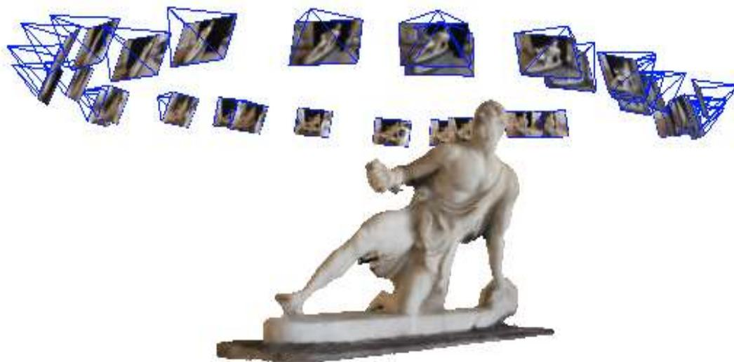
Fig. 14 - Processo di rilievo fotografico, posizione delle immagini riprese.
