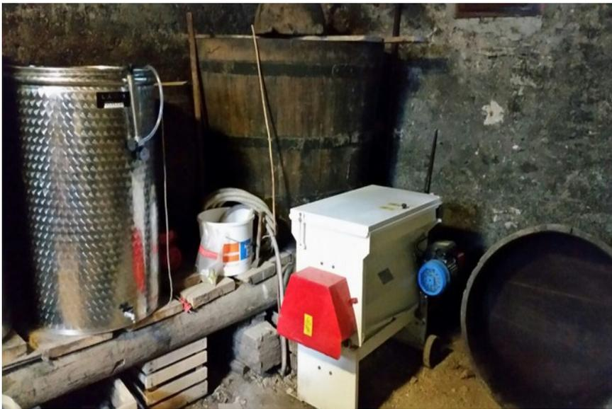
Fig.32 Si notano partendo da sx: un tino in acciaio inox, un tino in legno, una pigiadiraspatrice elettrica, e una sottospina in legno.(cantina Carlo Maddalozzo)
