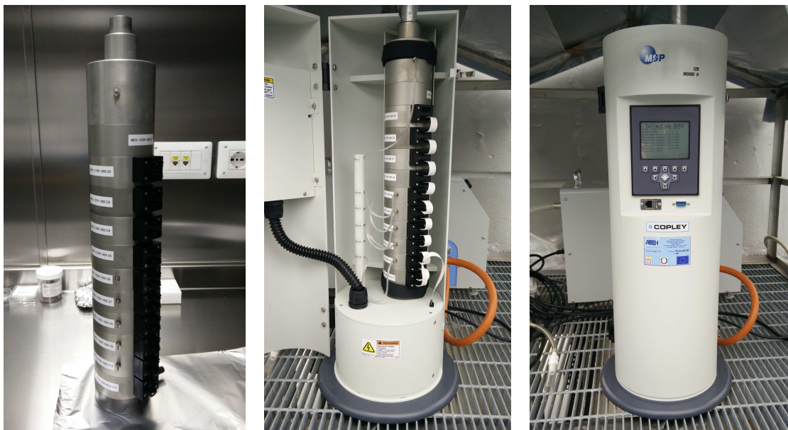
Figura A.3: L'impattore assemblato e inserito nell'alloggiamento (a sinistra ed al centro) e l'alloggiamento chiuso
