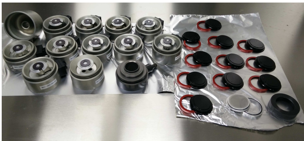
Figura A.1: I 12 stadi del campionatore con la testata (in alto a sinistra), lo stadio di fondo per l'aspirazione (in basso al centro) e tutti gli alloggiamenti per il posizionamento dei dischi in alluminio (a destra)
