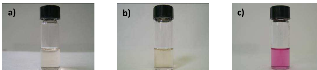
Figura 34. Soluzione del cromoforo ottenuta cambiando il volume di HCl 6 M utilizzato: (a) 1 mL; (b) 200 µL; (c) 100 µL
