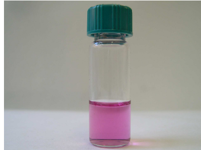
Figura 4. Colorazione caratteristica del cromoforo ottenuto dalla reazione tra Hyp ossidata a pirrolo e la DMAB
