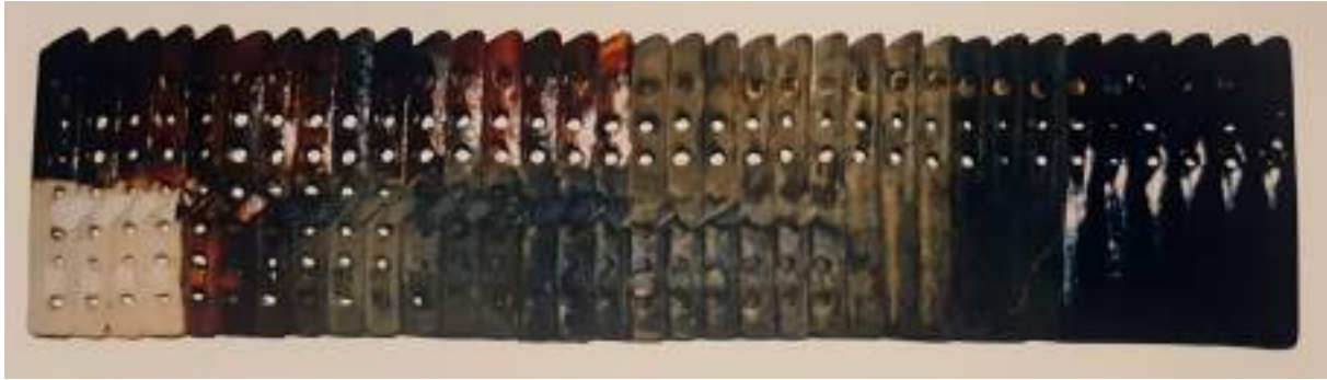
Fig.16 Vari passaggi della laccatura di un saneita
