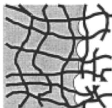
Figura 2.11: Al punto critico il raggio del menisco del liquido è uguale al raggio dei pori, la tensione capillare è massima. È questo lo stadio dell'essiccazione in cui è più probabile che avvengano fratture.
