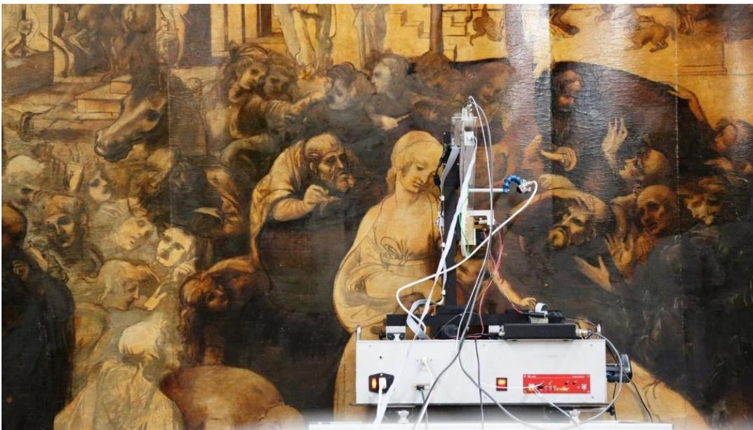
Fig.45: Scanner XRF a supporto del restauro relativo all'*Adorazione dei Magi* di Leonardo da Vinci, laboratori dell'Opificio delle Pietre Dure, Firenze.
