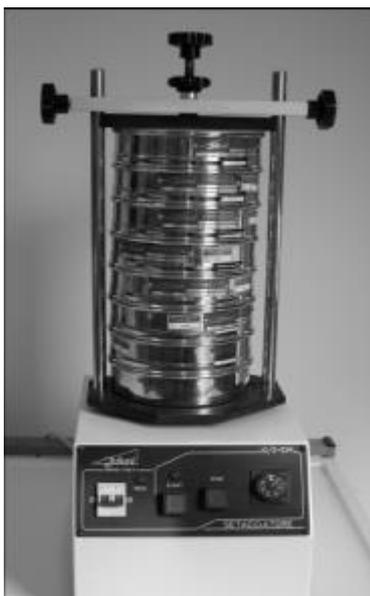
Figura 7 Setacciatore meccanico utilizzato per classare il sedimento
