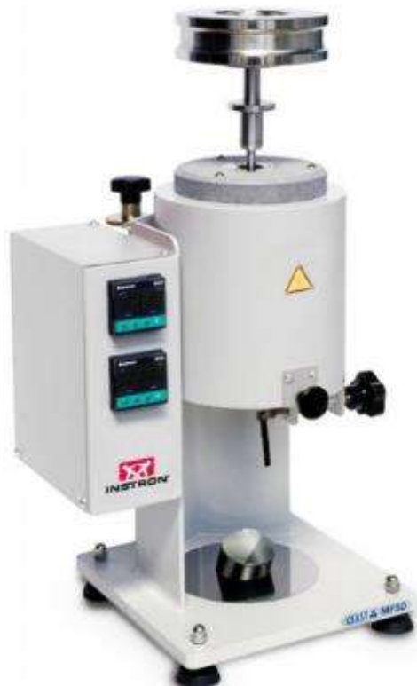
Figura 54. Testers Melt Flow CEAST MF 10 utilizzato per determinare l'indice di fluidità.
