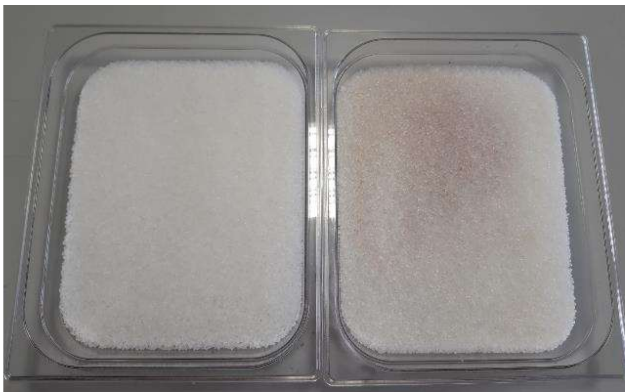
Figura 40. Confronto di PA6 vergine a sx con PA6 deumidificato con leggera "rosatura" a dx.
