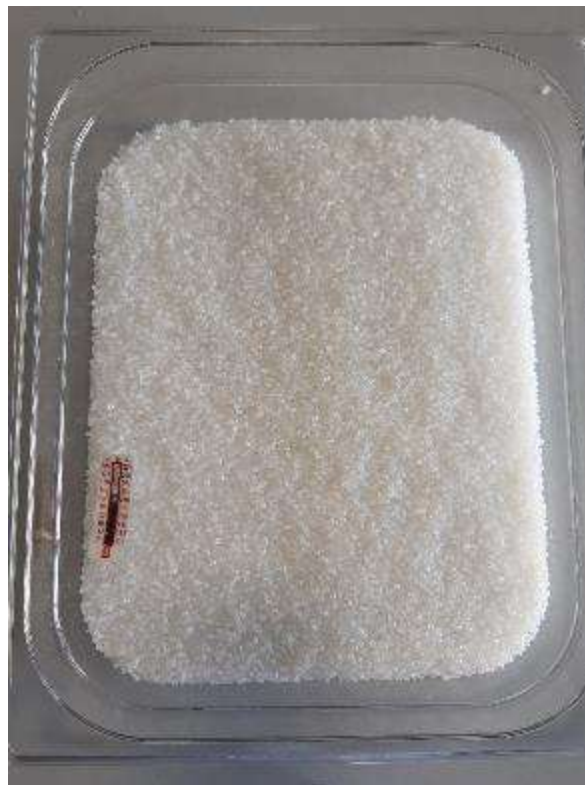
Figura 41. PA6 trattata a 100^{\circ}\text{C} con campionatura 2h.
