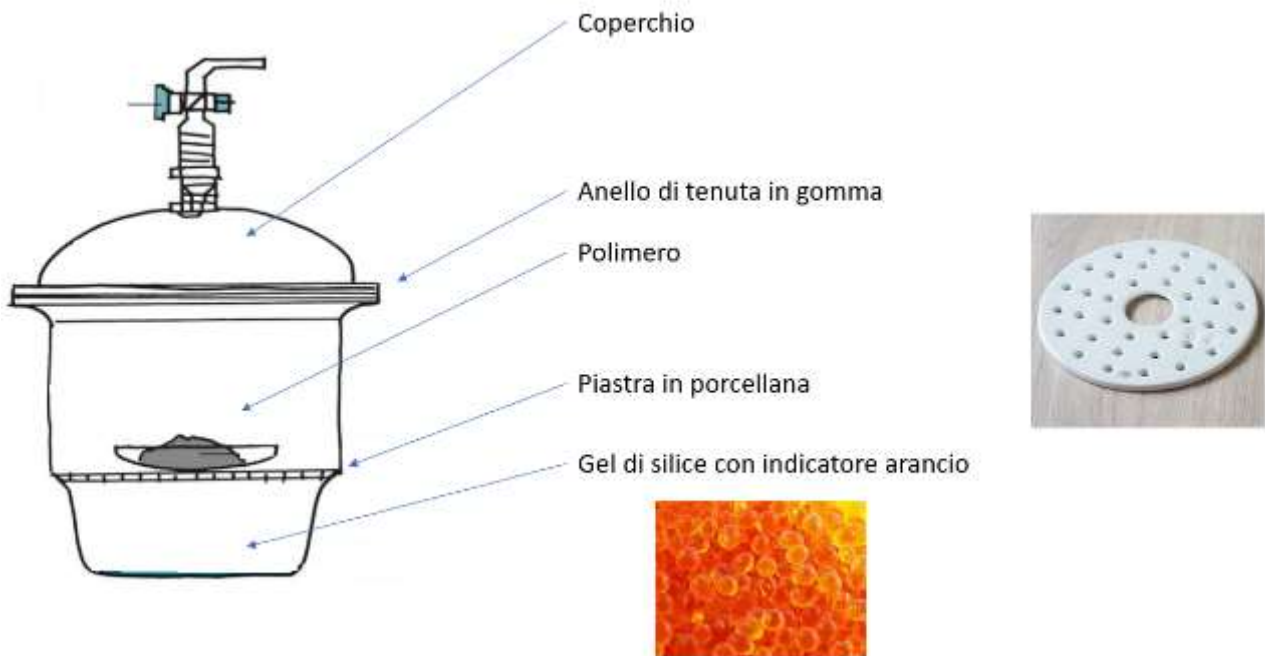
Figura 39. Essiccatore utilizzato per "mantenere" l'umidità del materiale polimerico.
