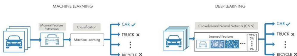
“Confronto di un approccio di machine learning (a sinistra) e deep learning (a destra) nella categorizzazione dei veicoli”
