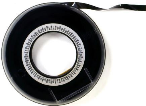
Figura 1. Bobina di nastro magnetico per memoria a nastro.
