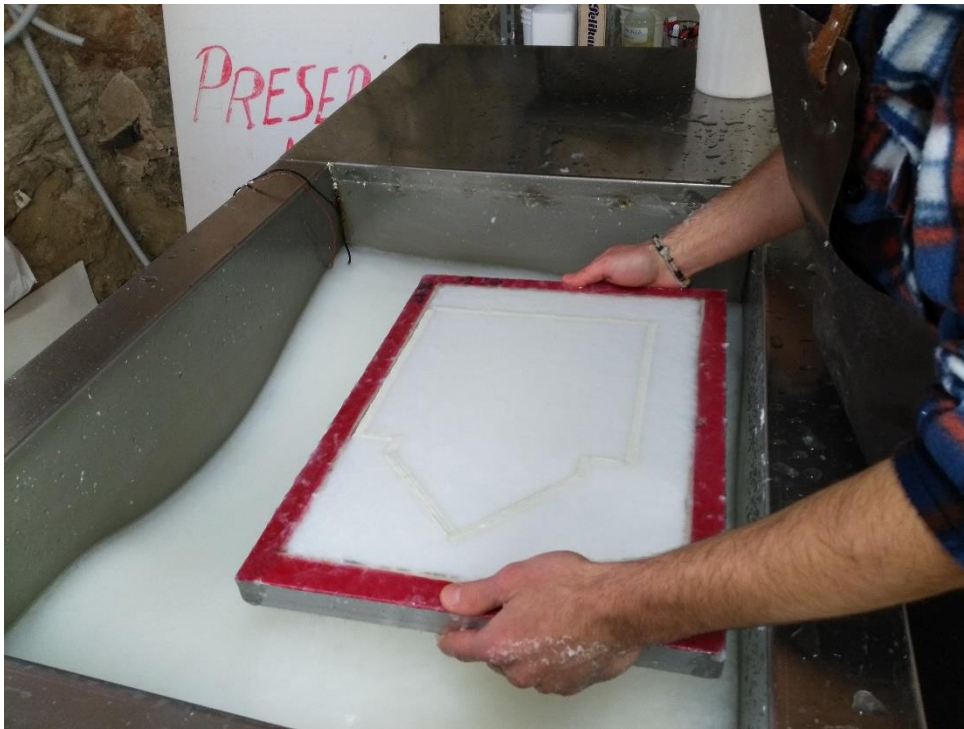
Lavorazione dell'impasto nel tino con telaio in nylon, per la realizzazione di buste
