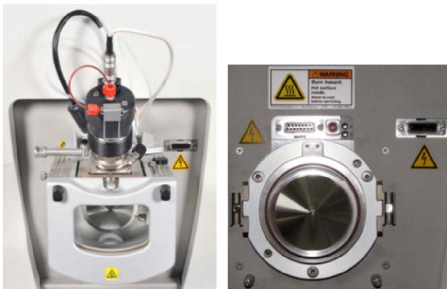
Figura 43 Visione della camera di ionizzazione del campione e dello sweep cone.
