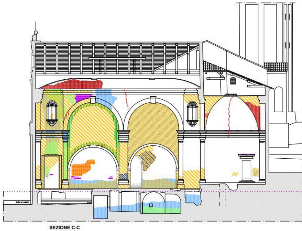
Fig. 28. Individuazione patologie di degrado della chiesa di San Paolo, Monselice. Sezione C-C.
