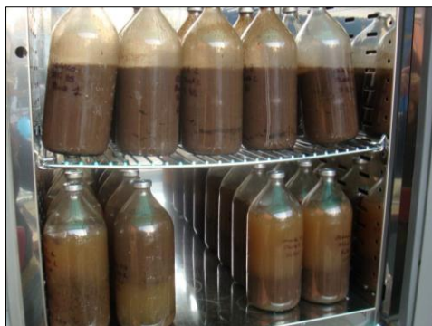
Figura 11 Foto dei reattori batch all'interno della stufa
