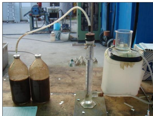
Figura 13 Foto dell'apparato strumentale per la misura della produzione del biogas
