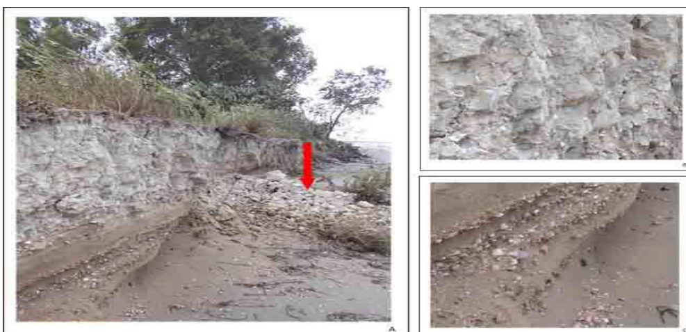
Figura 98. Stratigrafia della cassa di colmata B nell'area centro-Sud (A) e relativi dettagli (B-C). Fotografia del 16 giugno 2014.
