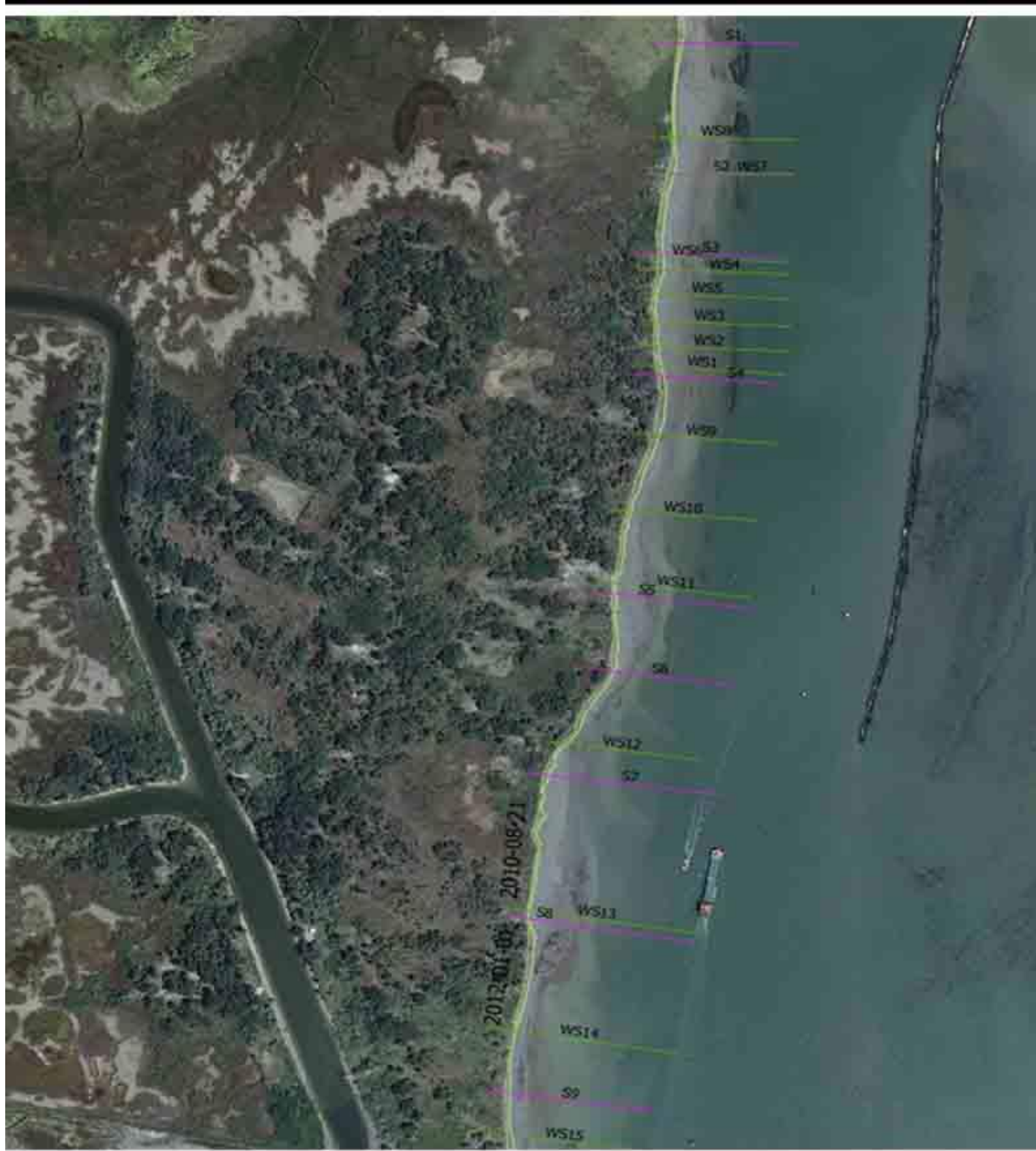
Figura 120. Immagine satellitare nell'anno 2012. Linea di riva nel 2010 e nel 2012, sezioni (S1-S9) e (WS1-WS15).
