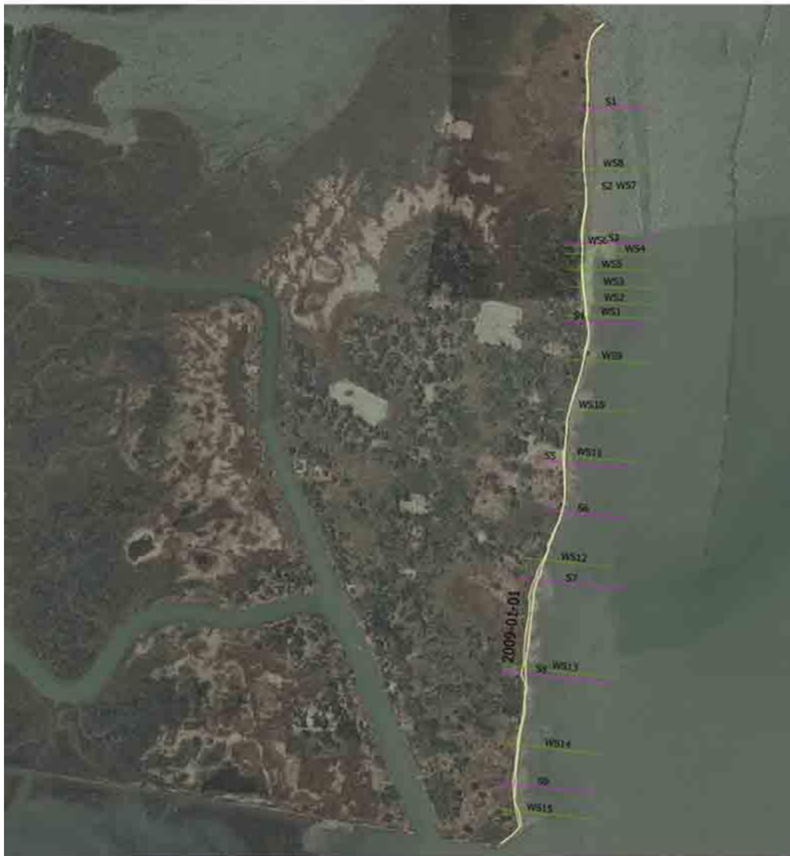
Figura 118. Immagine satellitare nell'anno 2009. Linea di riva nel 2005 e nel 2009, sezioni (S1-S9) e (WS1-WS15).
