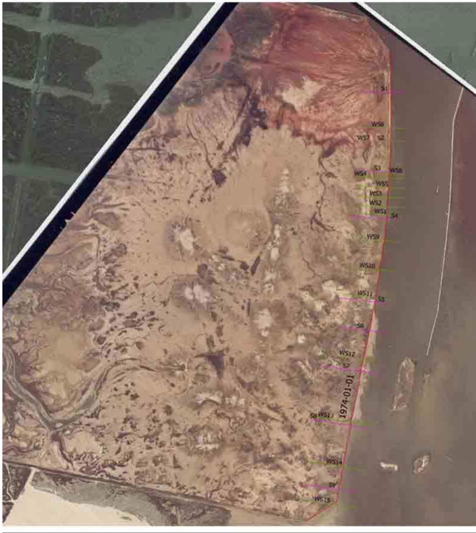
Figura 112. Fotografia aerea nell'anno 1974 georeferenziata sull'immagine satellitare del 2009. Linea di riva nel 1974 e sezioni (S1-S9) e (WS1-WS15).
