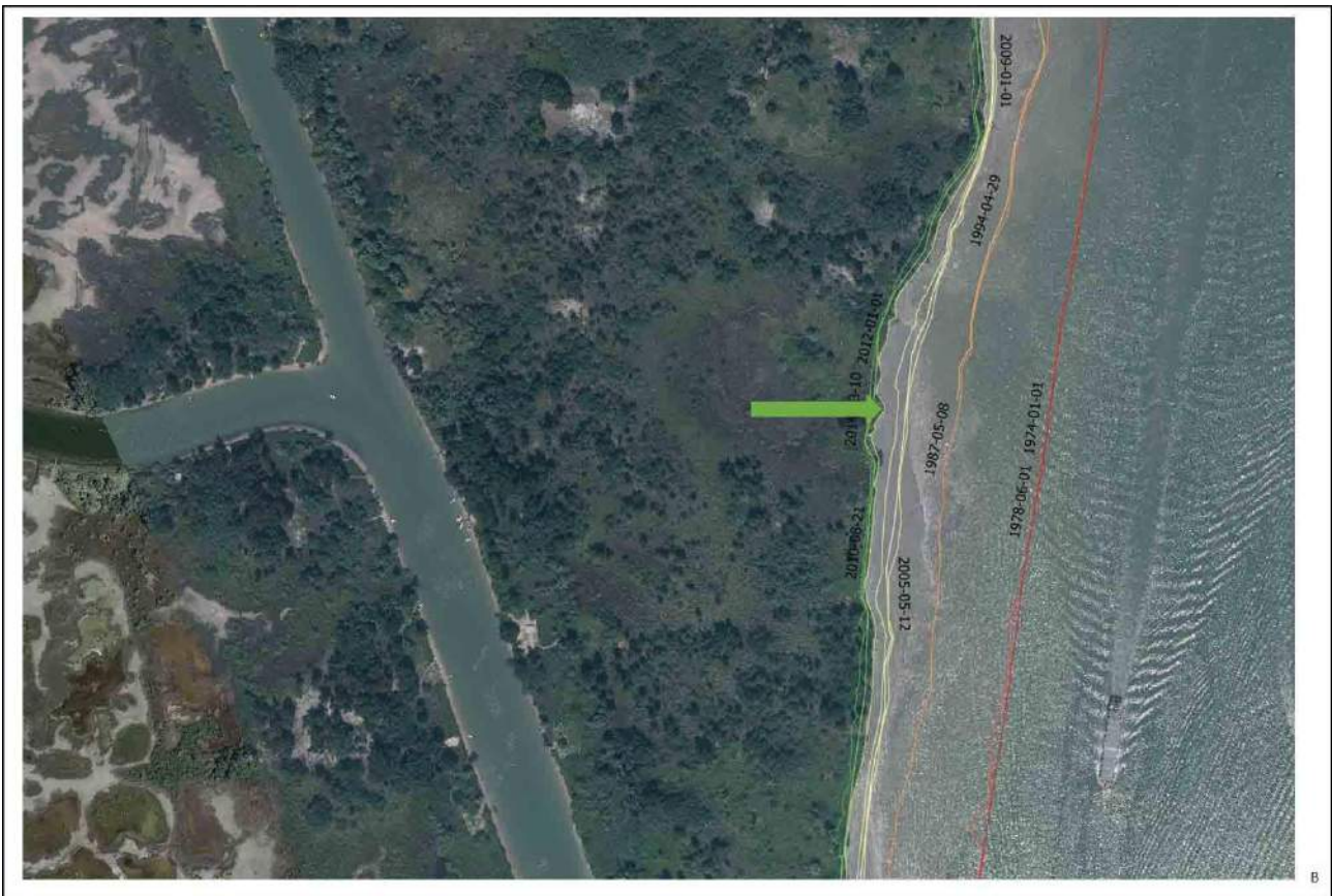
Figura 46. Linee di riva visibili sulla fotografia nell'anno 2010 (A) e rispettivo dettaglio dell'area centro-Sud (B). La freccia in verde chiaro indica la linea di riva per l'anno 2010.
